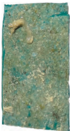
← Ausschnitt einer nicht gereinigten Folie mit sichtbaren Kalkverkrustungen
